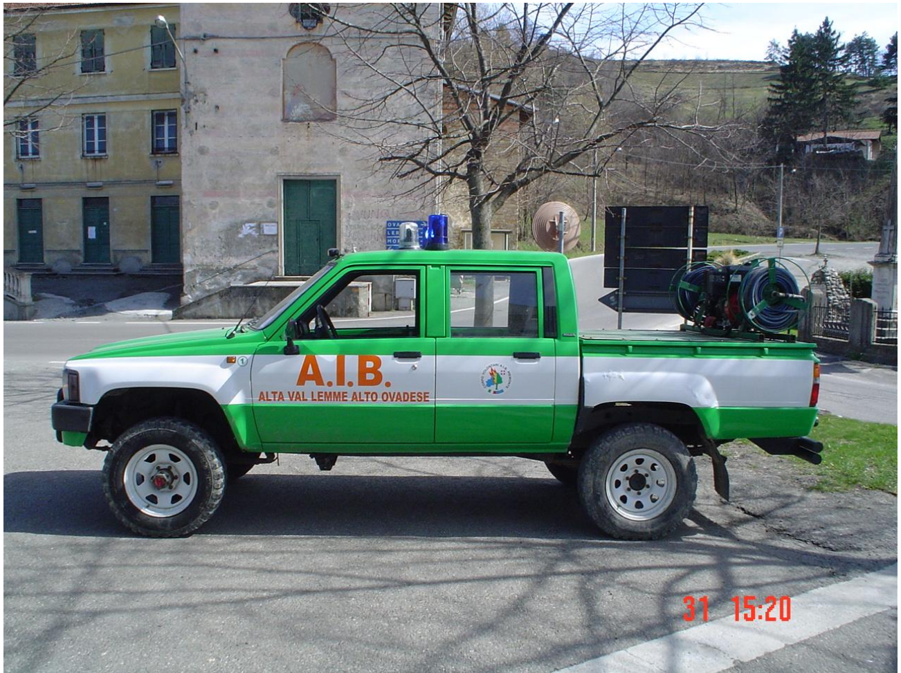
Toyota Hilux 4x4 - allestimento antincendio capacità litri 630.
