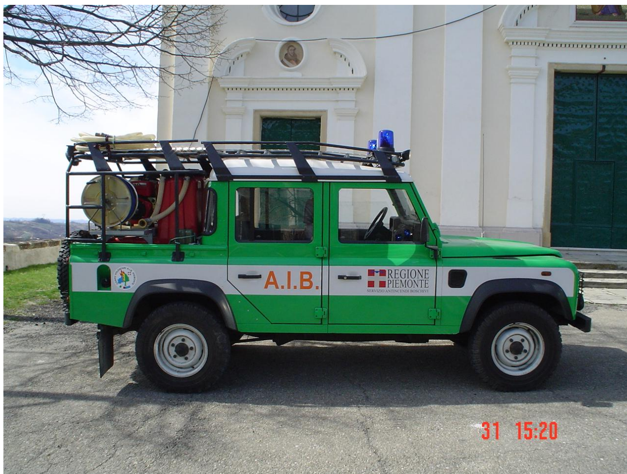
Land Rover Defender 110 CW - allestimento antincendio capacità litri 450.
